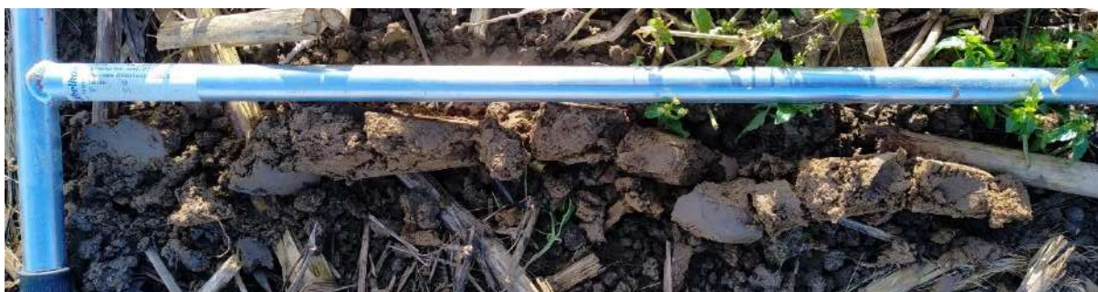
Figure 97 : Sondage pédologique 38 non caractéristique de zone humide.
