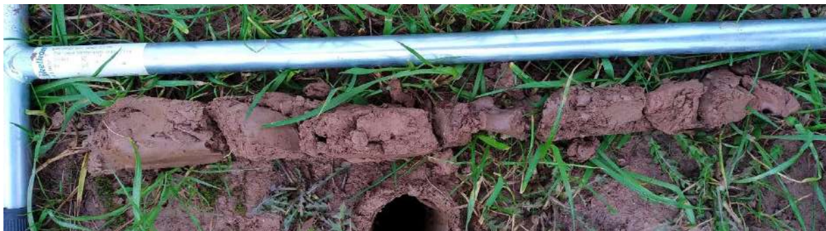
Figure 76 : Sondage pédologique 76 caractéristique de zone humide.
