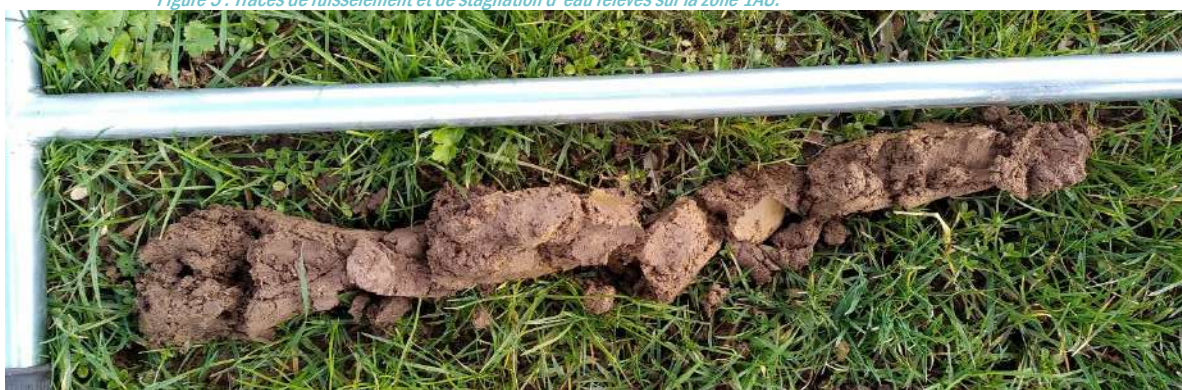
Figure 6 : Sondage pédologique 99 caractéristique d'un sol de zone humide par la présence d'un pseudogley dès la surface et son intensification en profondeur.
