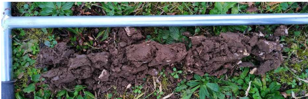
Figure 80 : Sondage pédologique 85 non caractéristique de zone humide.
