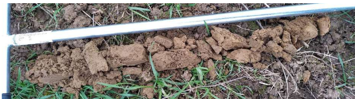
Figure 47 : Sondage pédologique 19 non caractéristique de zone humide.
