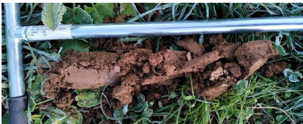
Figure 8 : Sondage 6 non caractéristique de zone humide. *
