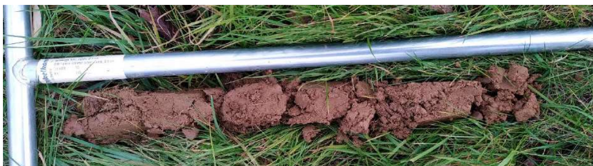
Figure 21 : Sondage pédologique 52 non caractéristique de zone humide.
