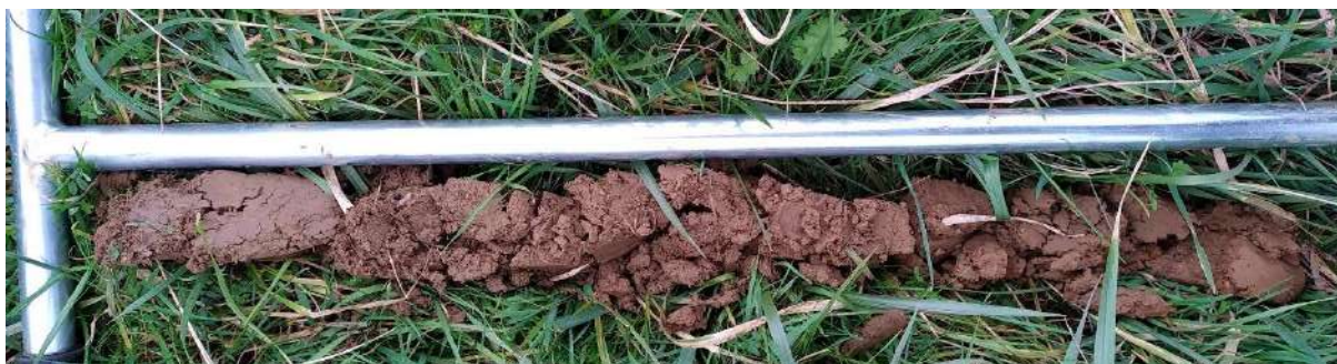
Figure 19 : Sondage pédologique 457 non caractéristique de zone humide.
