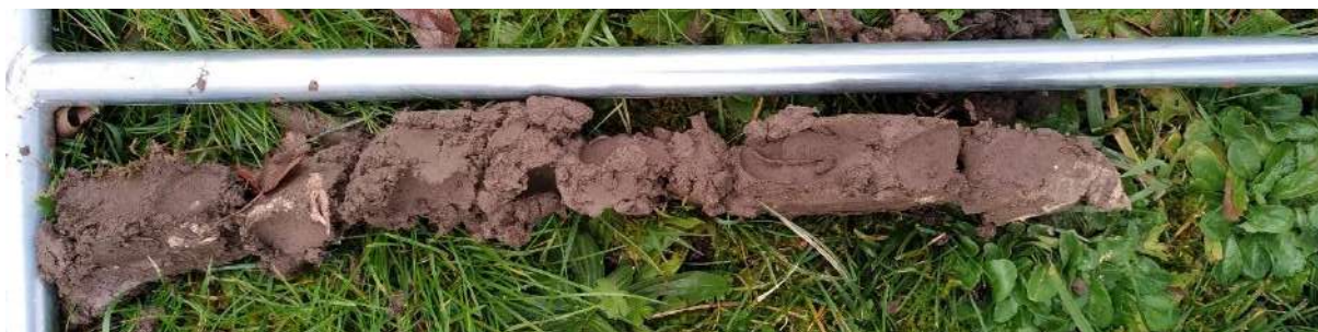
Figure 85 : Sondage pédologique 86 non caractéristique de zone humide.
