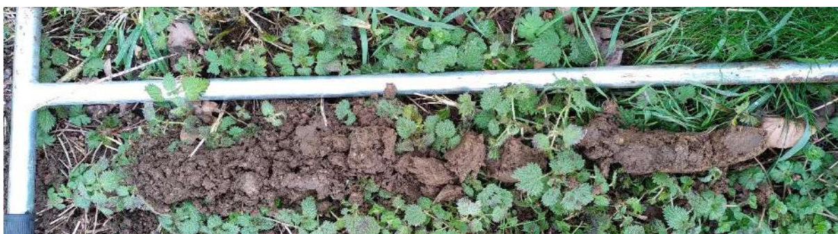
Figure 17 : Sondage pédologique 43 non caractéristique de zone humide.
