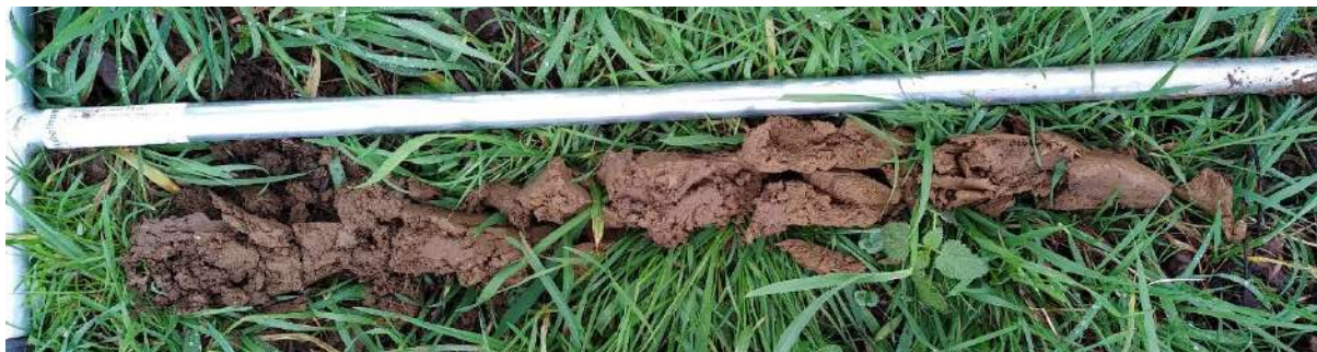
Figure 32 : Sondage pédologique 41 non caractéristique de zone humide.
