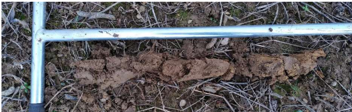
Figure 27 : Sondage pédologique 45 non caractéristique de zone humide.
