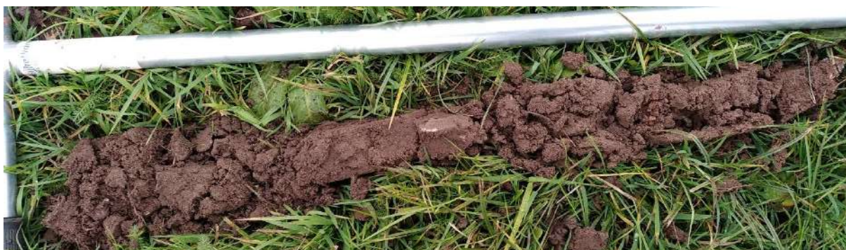
Figure 83 : Sondage pédologique 87 non caractéristique de zone humide.
