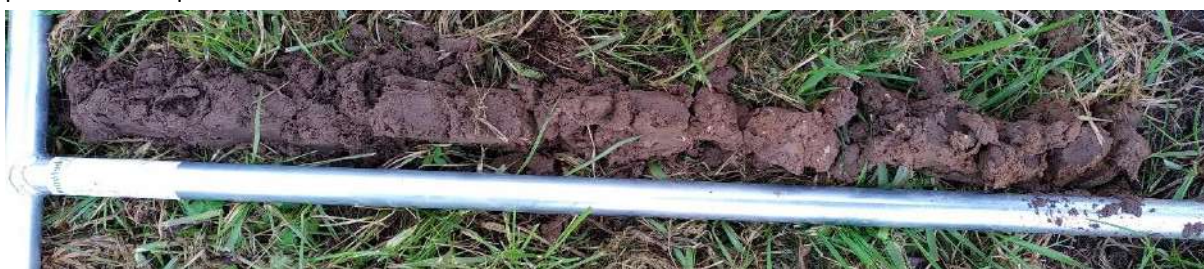
Figure 81 : Sondage pédologique 88 non caractéristique de zone humide.
