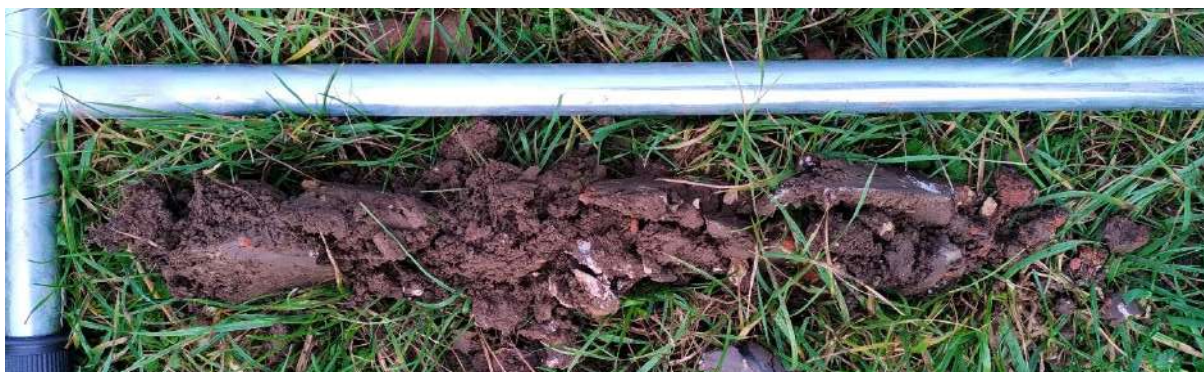
Figure 51 : Sondage 35 caractéristique d'un sol anthropique.
