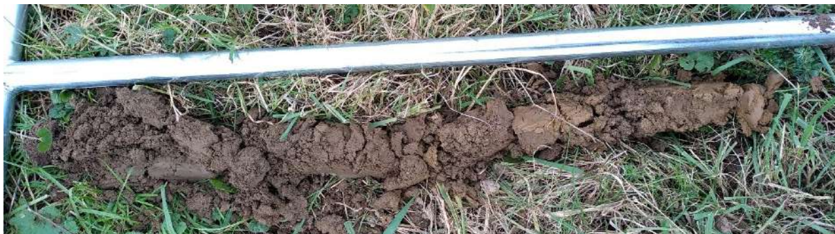
Figure 56 : Sondage pédologique 29 non caractéristique de zone humide.
