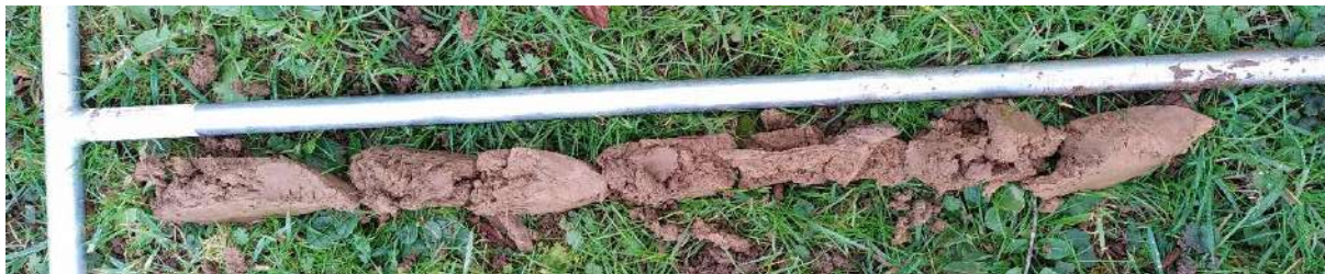
Figure 33 : Sondage pédologique 42 non caractéristique de zone humide.
