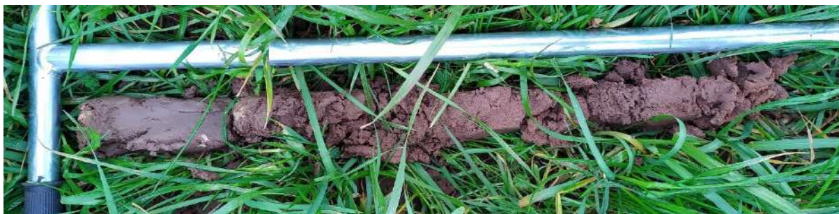
Figure 79 : Sondage pédologique 74 non caractéristique de zone humide.
