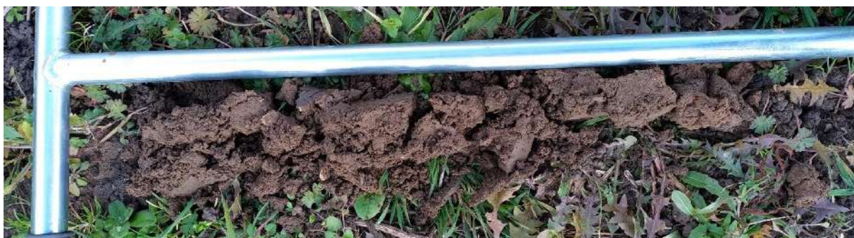
Figure 82 : Sondage pédologique 90 non caractéristique de zone humide.
