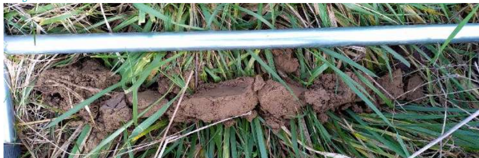
Figure 11 : Sondage pédologique 94 non caractéristique d’un sol de zone humide.
