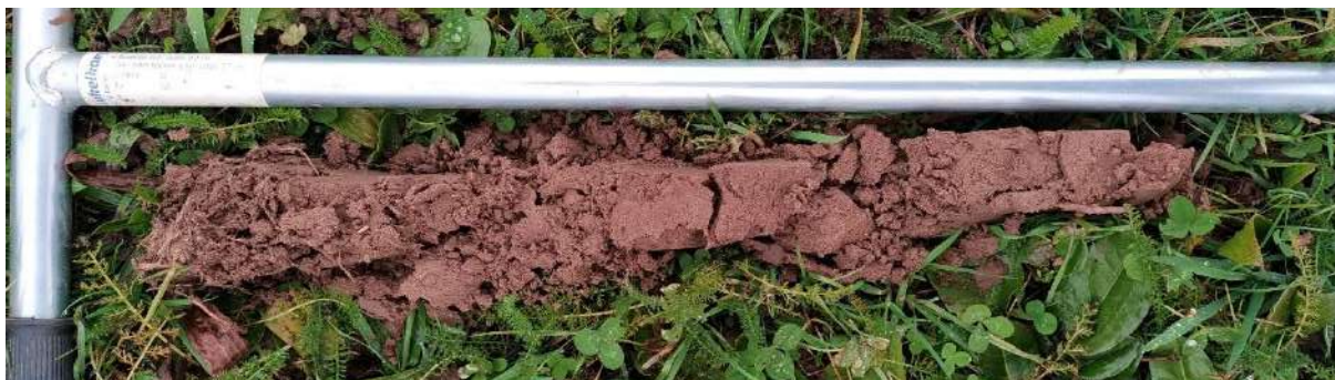
Figure 74 : Sondage pédologique 82 non caractéristique de zone humide.
