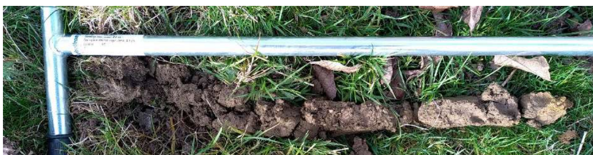
Figure 61 : Sondage pédologique 13 non caractéristique de zone humide.
