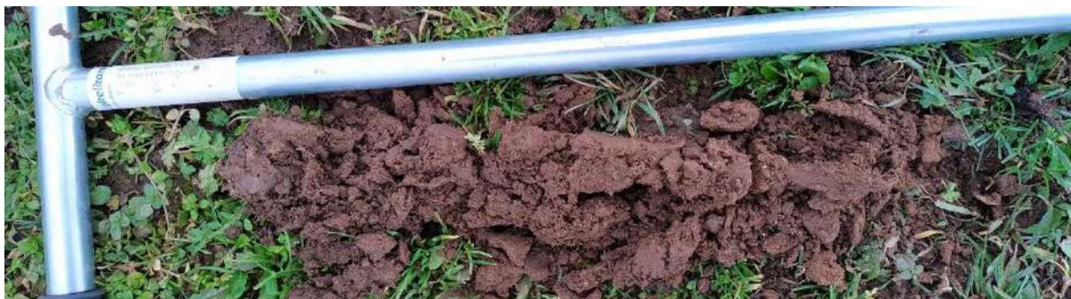
Figure 78 : Sondage pédologique 91 non caractéristique de zone humide.
