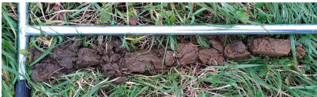
Figure 44 : Sondage pédologique 16 non caractéristique de zone humide.
