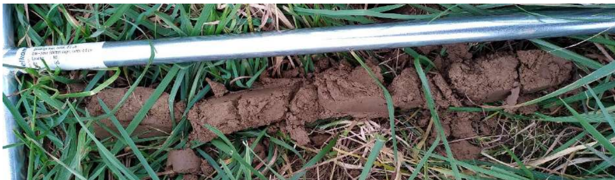
Figure 54 : Sondage pédologique 28 non caractéristique de zone humide.
