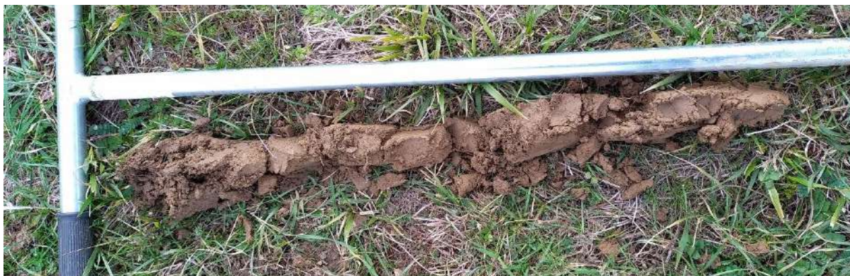
Figure 14 : Sondage pédologique 48 non caractéristique de zone humide.
