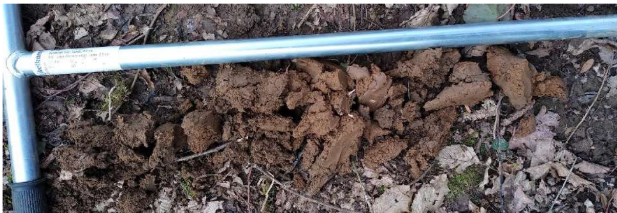
Figure 26 : Sondage pédologique 46 non caractéristique de zone humide.
