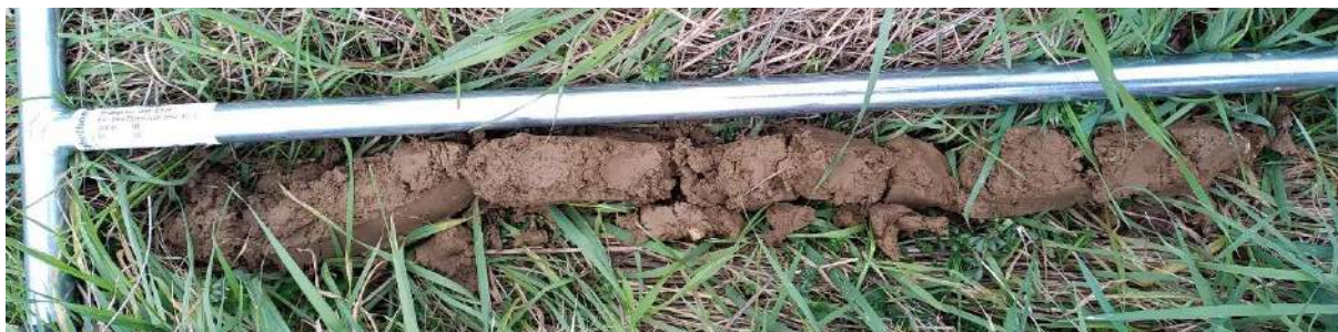
Figure 42 : Sondage pédologique 17 non caractéristique de zone humide.
