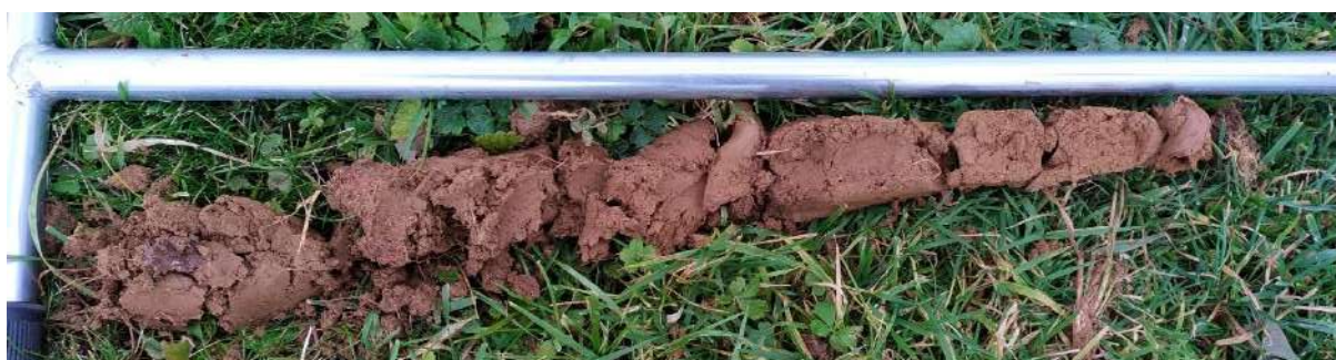
Figure 71 : Sondage 110 non caractéristique de zone humide.
