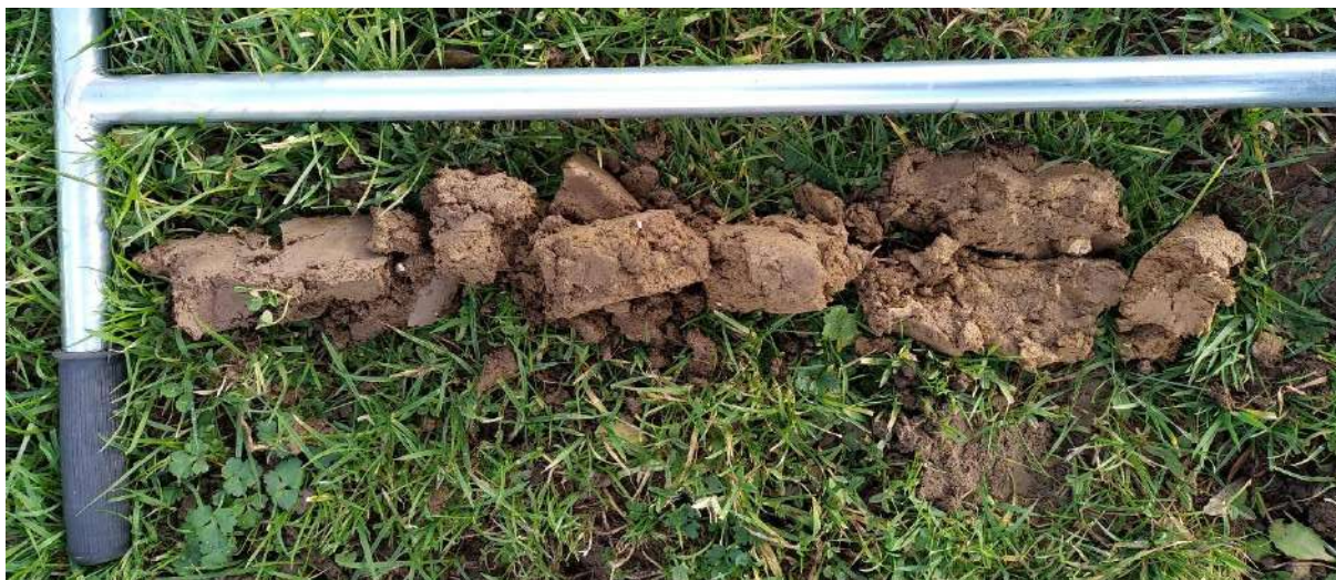
Figure 39 : Sondage pédologique 96 caractéristique d'un sol de zone humide par la présence d'un pseudogley dès 15cm et son intensification en profondeur.
