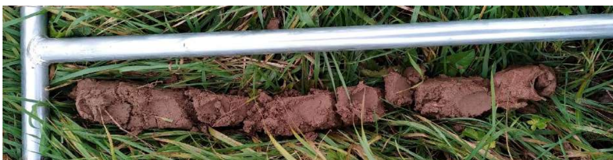
Figure 77 : Sondage pédologique 75 non caractéristique de zone humide.
